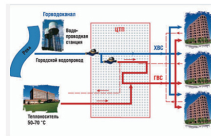
Рис. 4. Схема закрытой системы горячего водоснабжения
